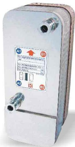
空氣乾燥機專用板式熱交換器，除體積小可節省空間，熱傳效能高，兼具預冷器(回溫)、蒸發器、氣水分離器三機一體，專利氣水分離設計可完全去除壓縮空氣中的水份，且非濾材設計，免去堵塞的問題，是空氣乾燥機不可或缺的重要原件。
