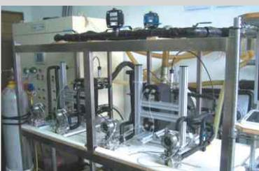
· 熱交換器性能測試系統
