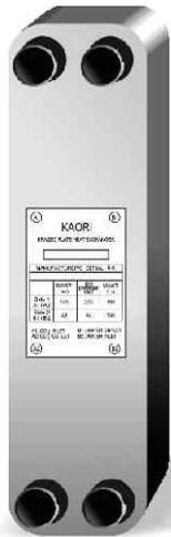
高力超高壓型熱交換器，可應用在R744(CO<sub>2</sub>)熱泵及冷凍系統內之蒸發器、冷凝器、節能器及油冷卻器等。產品型式多，可針對不同客戶壓力需求，且內外兩側流道皆可耐高壓，依使用壓力可分為70bar、100 bar、140 bar三種產品。外觀小巧、熱傳性能優異、低壓降是產品最大特色。並通過嚴格的產品檢驗把關，最大破壞壓力高達650 bar，壓力反覆試驗次數超過10萬次。
