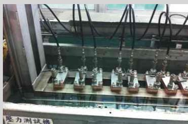
· 壓力測漏設備
