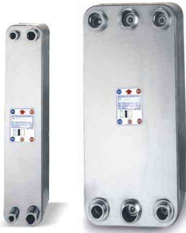
標準K系列硬銲型板式熱交換器為高力所有產品中型式最多之熱交換器，應用也最為廣泛。(K\*\*\*S：表示45bar加強型，K215：為Dual Circuit-6孔型) 主要用途：冷凍空調、熱泵、冰水機、油冷卻機、製程冷卻及加熱。
